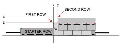
OVERLAP SHINGES ON EVERY ROW AT 14,5 cm USE THE VERTICAL LINE TO STAGGER SHINGLE HORIZONTALLY 12,5 cm
