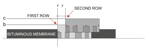
OVERLAP SHINGES ON EVERY ROW AT 14,3 cm USE THE VERTICAL LINE TO STAGGER SHINGLE HORIZONTALLY 16,5 cm
