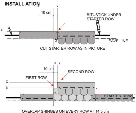
USE THE VERTICAL LINE TO STAGGER SHINGLE HORIZONTALLY 10 cm
